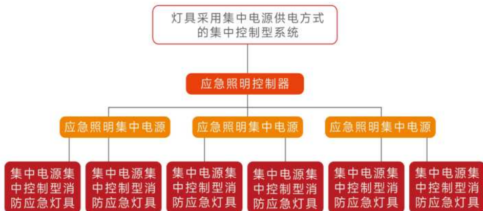
图A:灯具采用集中电源供电方式的集中控制型系统
